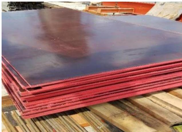
Gambar 4.9. Plywood atau multiplex
