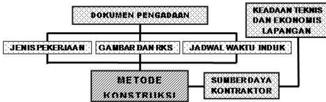
Gambar 3.12. Kerangka gagasan dan konsep metode optimal dalam pelaksanaan konstruksi
