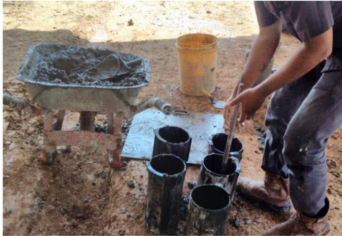
Gambar 4.24. Cetakan uji beton silinder dan alat uji slump
