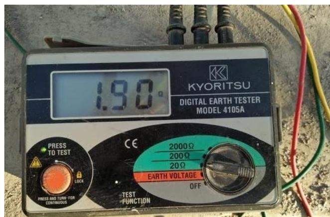
**Gambar 4.5 Hasil Pengukuran Tahanan Pentanahan Menggunakan Alat Ukur pada Bangunan *Compressor House***
