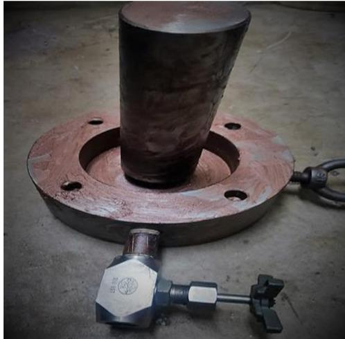
Gambar 4.1 Simulator mechseal yang telah di rakit
