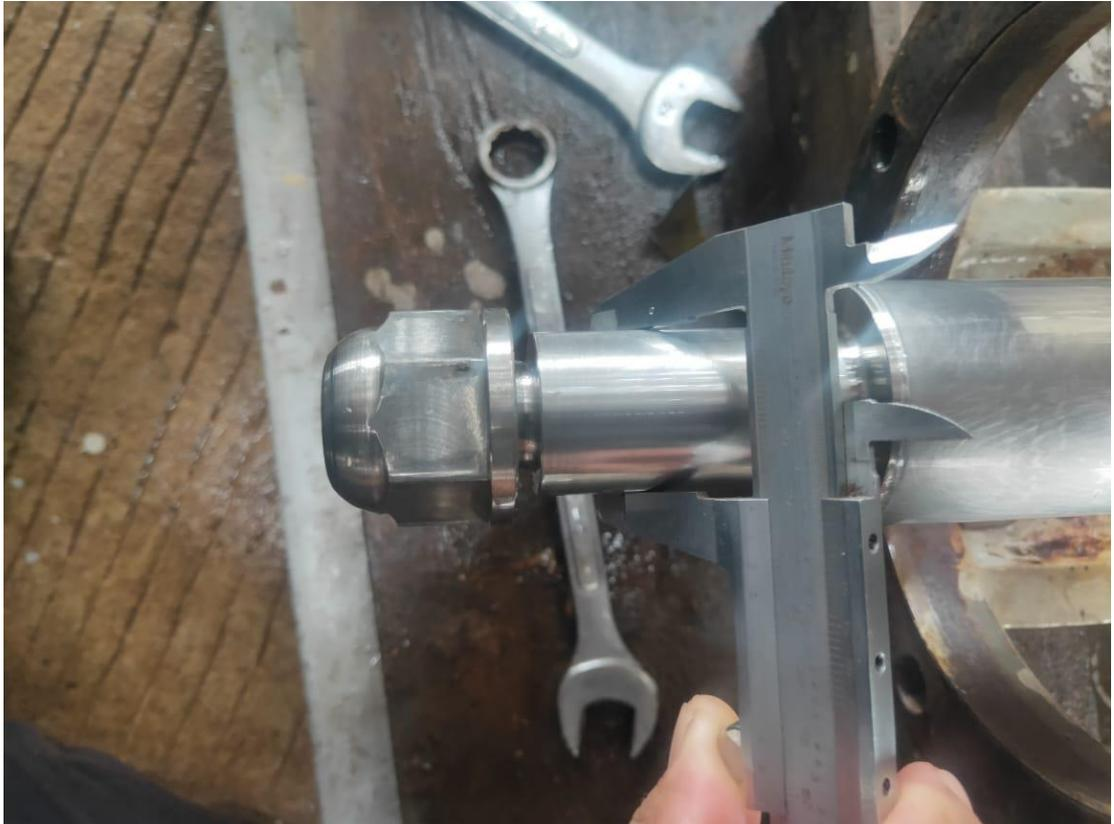
b. Pengukuran dimensi Panjang shaft sleeve pada pompa
