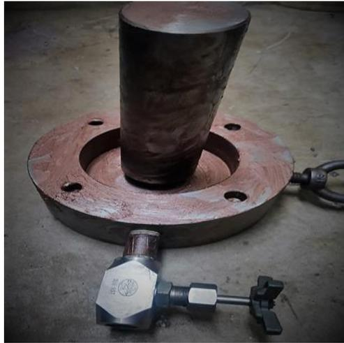
Gambar 4.1.2 Simulator mechseal yang telah di rakit
