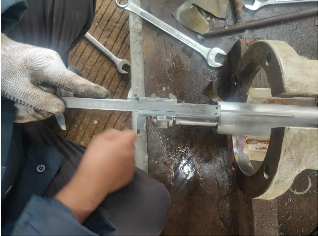
h. Pengukuran Diameter shaft Sleeve pada Mechseal
