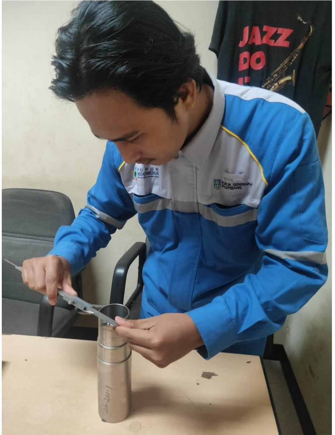
d. Pengukuran Ketinggian Sleeve Pada Mechseal
