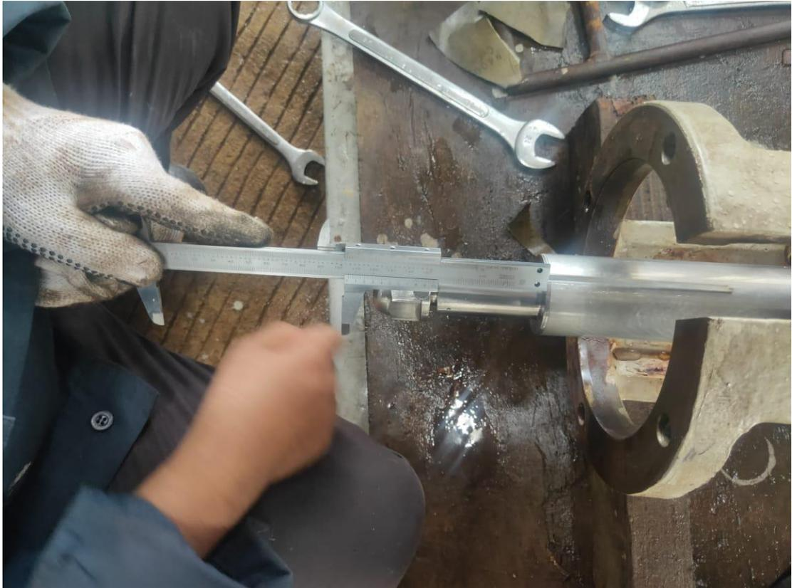
c. Pengukuran Diameter shaft Sleeve pada Mechseal
