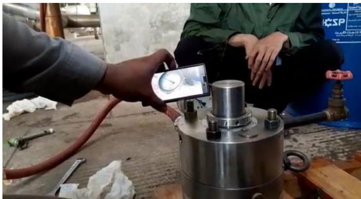
Gambar 4.1 Proses pengetesan yang dilakukan pada mechseal
