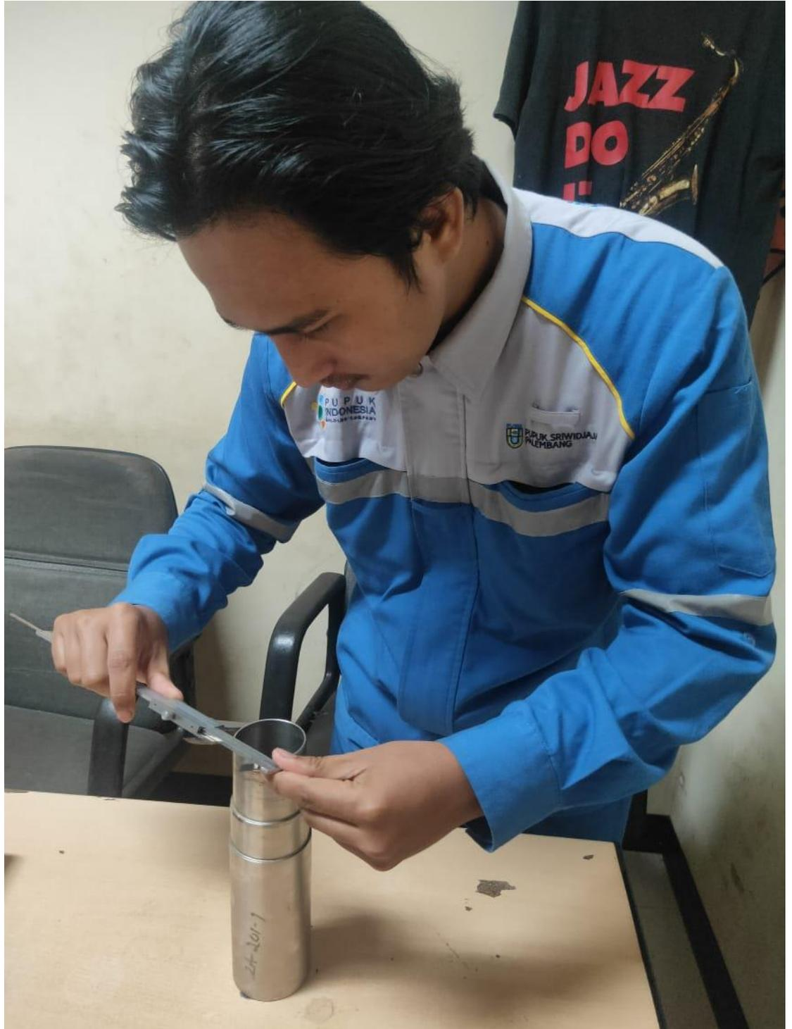
i. Pengukuran Ketinggian Sleeve Pada Mechseal
