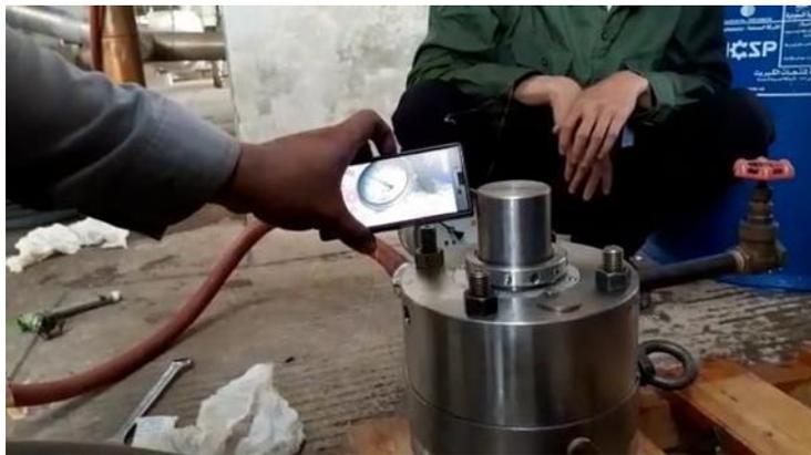
Gambar 4.1.3 Proses pengetesan yang dilakukan pada mechseal
