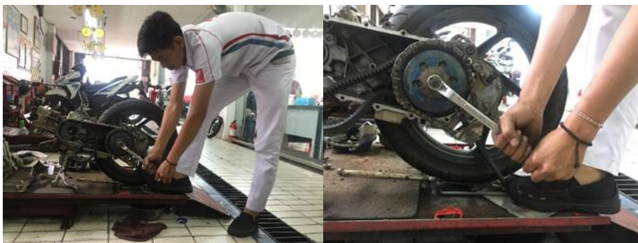
Gambar 3.1 Proses pengetesan yang dilakukan pada flywheel holder
