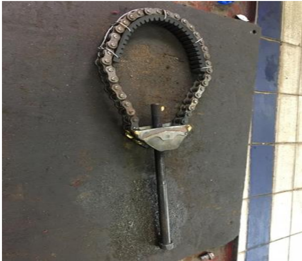
Gambar 4.1.1 Simulator flywheel holder yang telah di rakit
