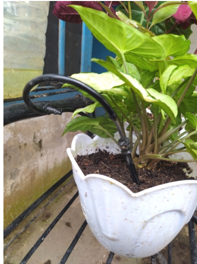
Gambar 4.5 Drip Stick yang di tancapkan ke tanah
