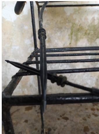
Gambar 4.4 Drp Stick yang terhubung dengan selang 5mm
