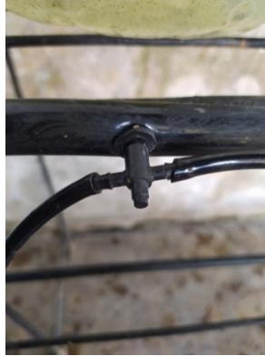
Gambar 4.3 Micro tee yang menghubungkan selang 16mm dan selang 5 mm
