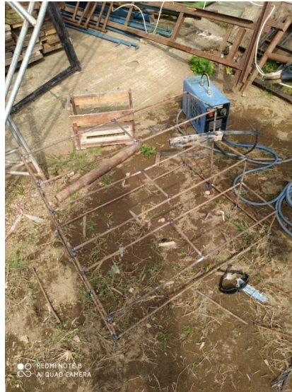
Gambar 4.1 Rak Tanaman yang telah di las
