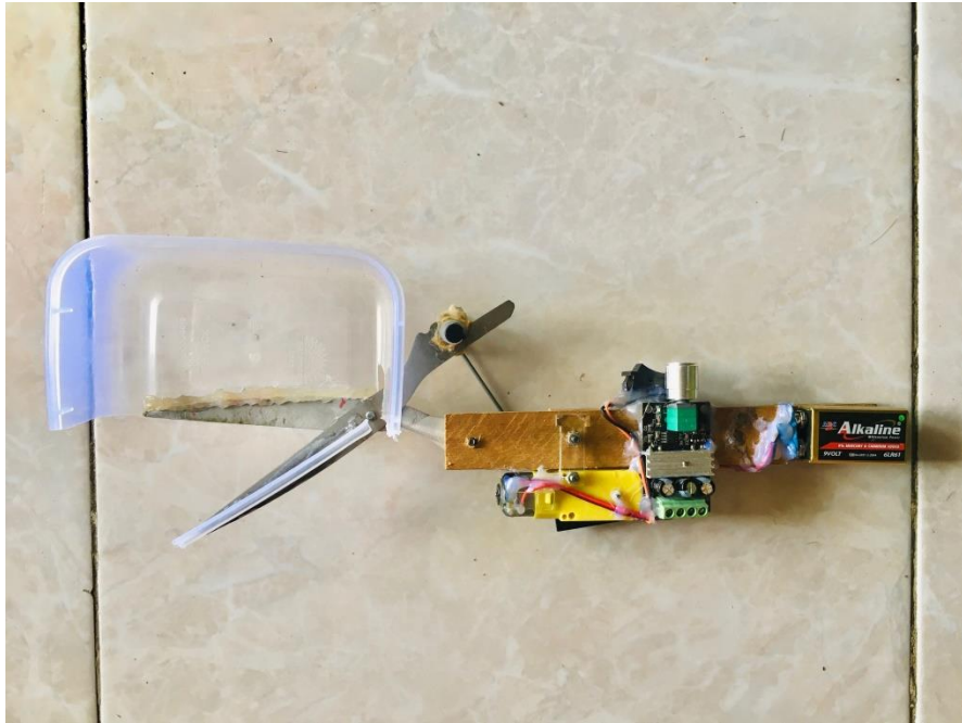
Gambar 15. APEDAT “Alat Pemetik Daun Teh” Dengan Sistem Otomatis Menggunakan Kendali Motor DC (Bagian Depan)
