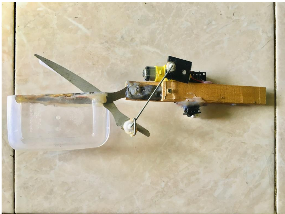
Gambar 16. APEDAT “Alat Pemetik Daun Teh” Dengan Sistem Otomatis Menggunakan Kendali Motor DC (Bagian Belakang)
