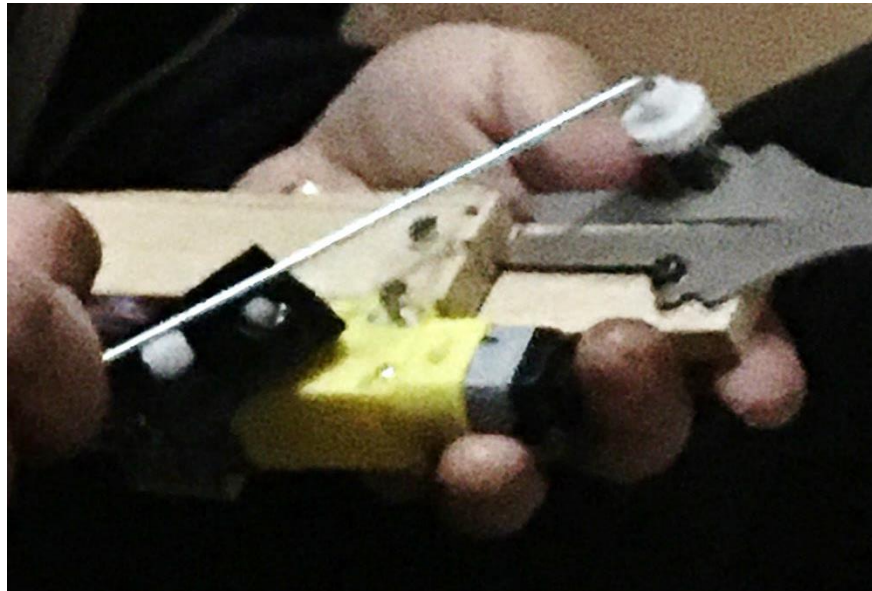
Gambar 14. Proses Produksi Pembuatan APEDAT (Pemasangan Besi Pengait Antara Mata Pisau dan Akrilik Pada Putaran Motor DC )
