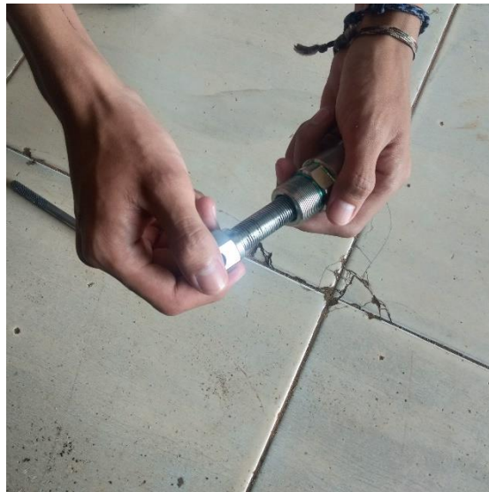
Gambar 4. Proses Perakitan Treker
