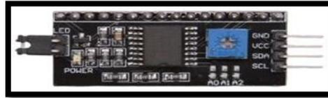
Gambar 3.5. Modul 12C Converter
