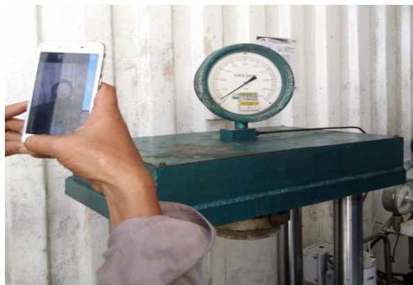
Gambar 4.1. (1) Beton uji silinder, (2) Penimbangan beton uji, (3) Mesin uji sedang menguji beton uji
