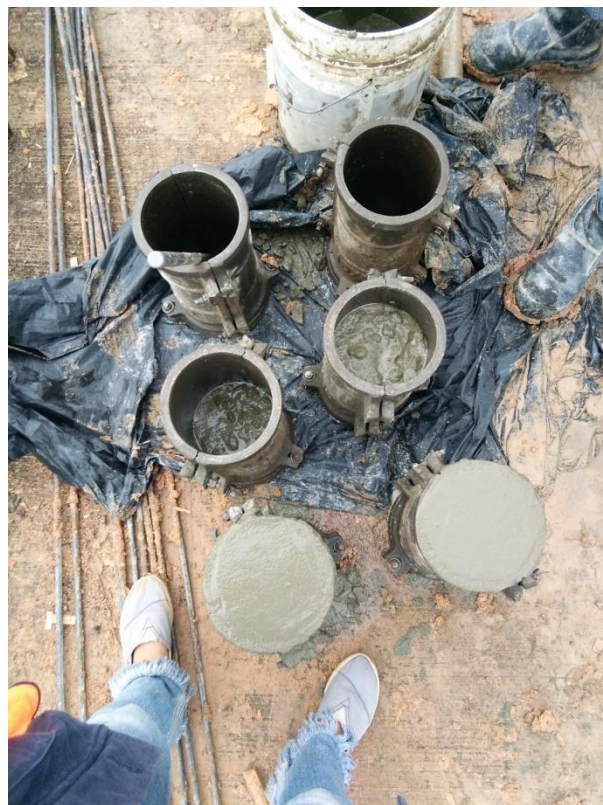
Gambar 4.2. Pengisian beton uji ke cetakan silinder
