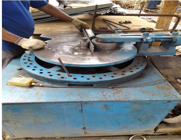
Gambar 4.8 Proses pembentukkan/pembengkokkan besi
