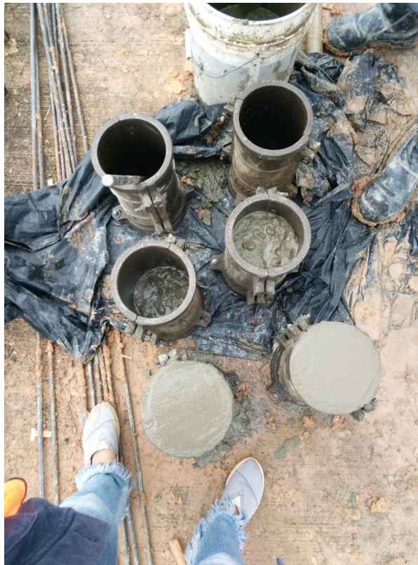
Gambar 4.6 Pengisian beton uji ke cetakan silinder
