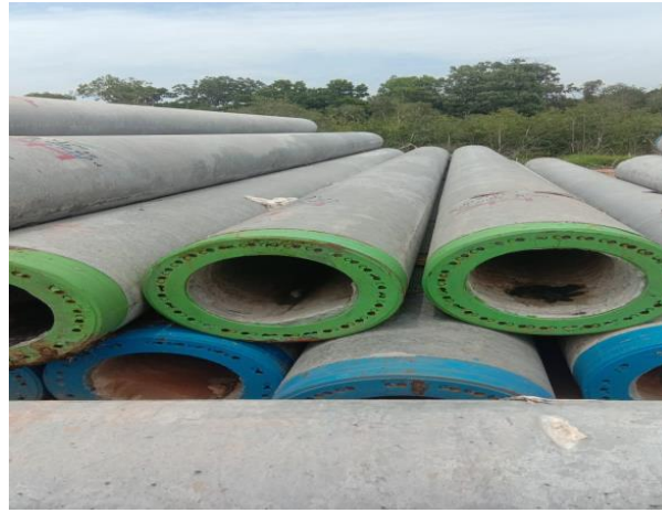
Gambar 2.5. Tiang Pancang Beton (Dokumen Pribadi)
