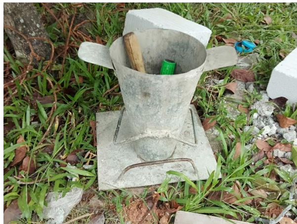
Gambar 4.1 a. Cetakan/Kerucut terpancung ( Sumber : Dokumen sendiri, 2020 )
