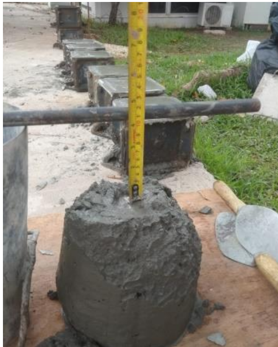
Gambar 3.6 a. Tes Uji Slump ( Sumber : Dokumen sendiri, 2020 )
