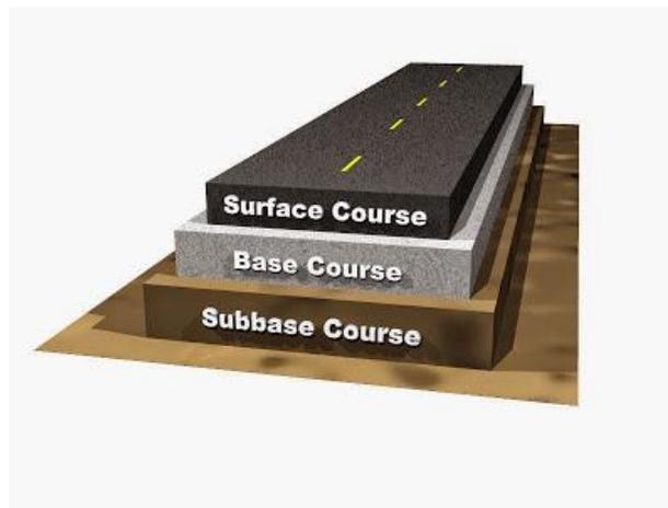
*Gambar 3.1. Lapisan Perkerasan*
