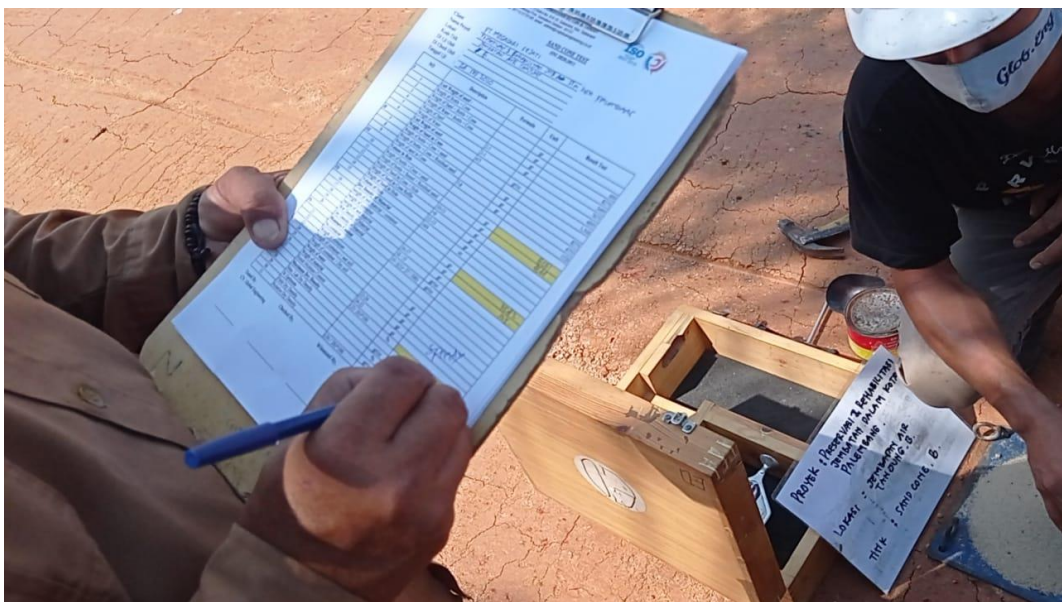
Gambar 4.7 Pengisian Data Hasil Tes Sand Cone
