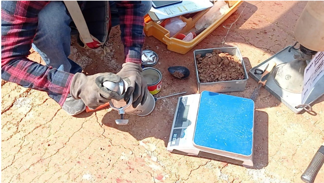
Gambar 4.6 Pengeringan Tanah Menggunakan Karbit
