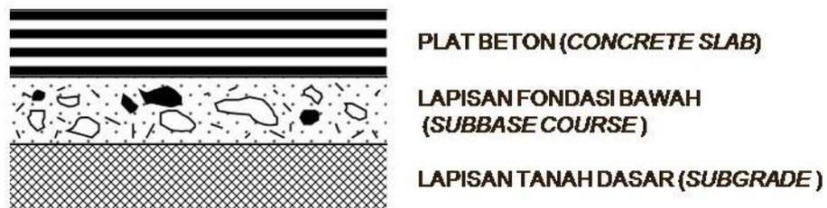
Gambar 3.3 Struktur Perkerasan Kaku
