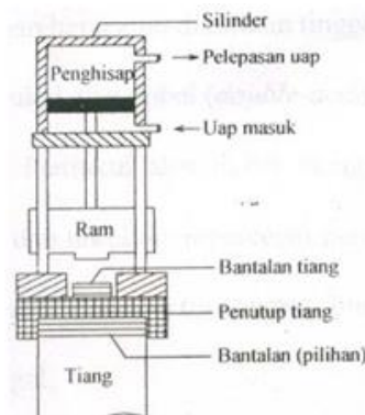
Gambar 3.4 Pemukul aksi tunggal ( single acting hammer ).
