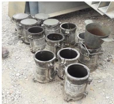
Gambar 4.27 Pengambilan Sampel Benda Uji Beton
