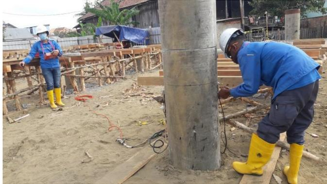
Gambar 5.3 Proses Pemasangan alat (PDA test) di Tiang Pancang
