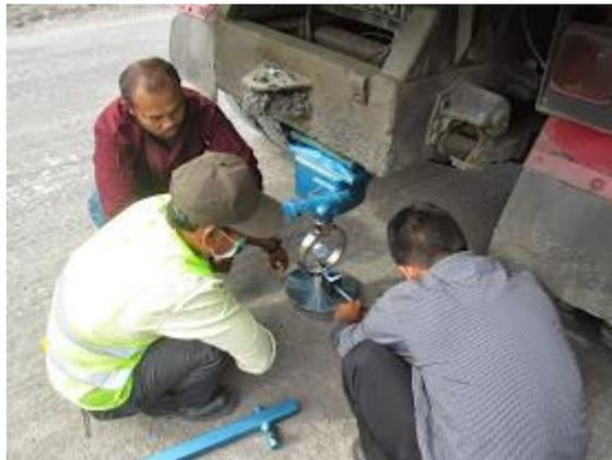
Gambar 4.1 Uji CBR menggunakan alat Field CBR Test
