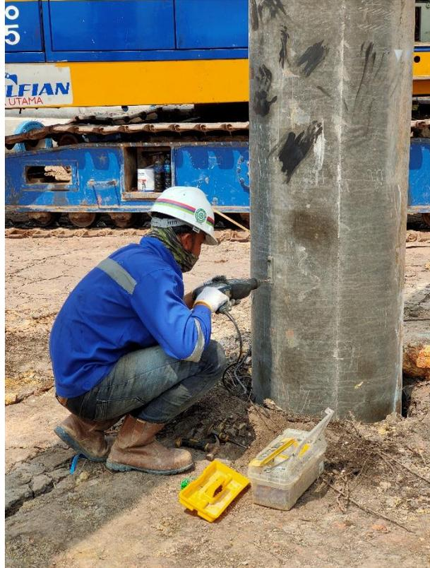
Gambar 4.14 Pemasangan Transduces dan Accelerometer
