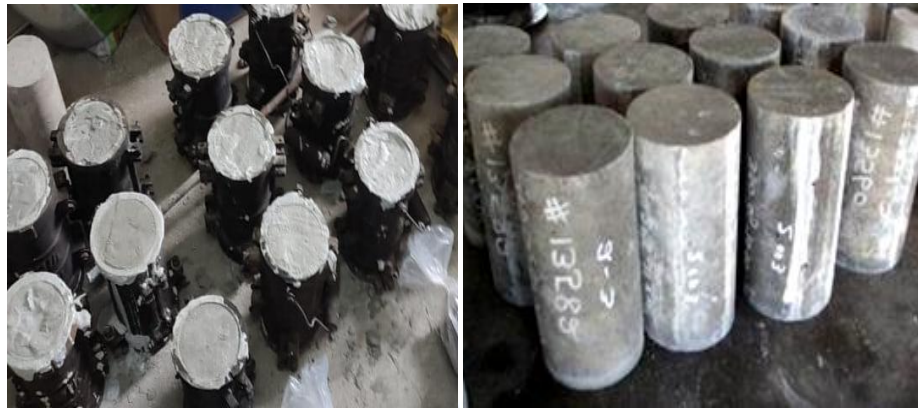
Gambar 1. Proses pencetakan beton uji (a) dan Beton uji yang telah mengeras dikeluarkan dari cetakan (b)
