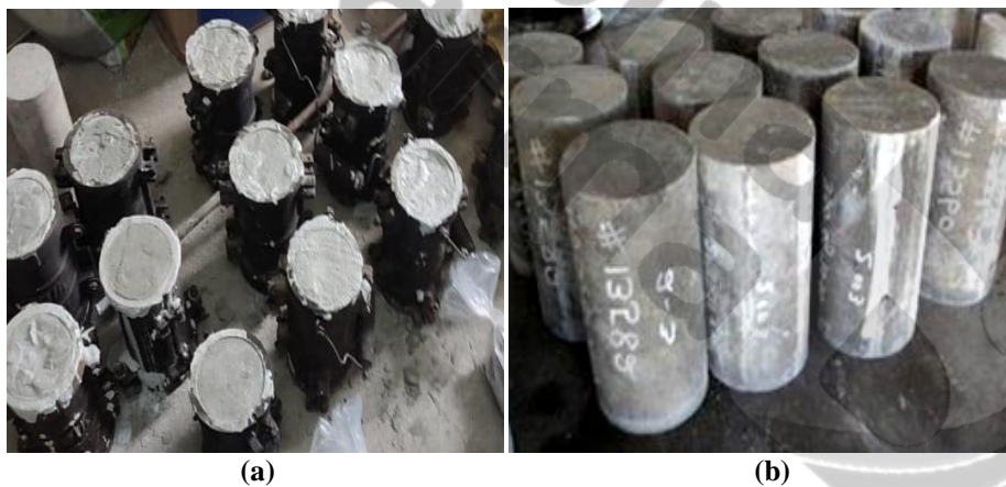
Gambar 1. Proses pencetakan beton uji (a) dan Beton uji yang telah mengeras dikeluarkan dari cetakan (b)
