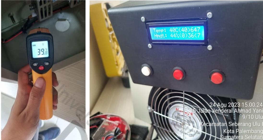
**Gambar 6. Pengujian Sensor DHT 22**
