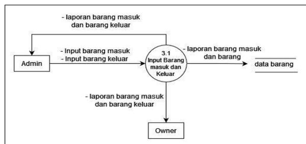
Gambar 7. Data Flow Diagram DFD Level 1 Proses Barang Masuk dan Keluar
