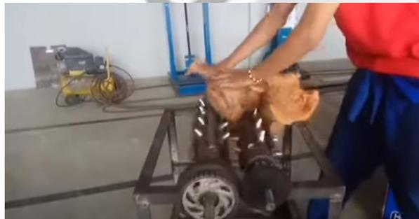
Gambar 1.2 Alat Pengupas Kelapa dan Dogan Semi Otomatis
