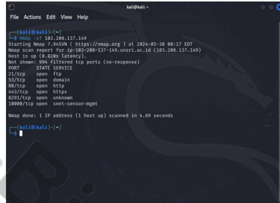
Gambar 9. pemindaian TCP dengan perintah -sT
