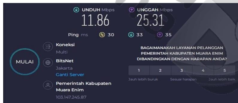
Gambar 15. Pengukuran kecepatan sinyal menggunakan aplikasi *speedtest* Pada Kantor UPTD Balai BKKBN.
