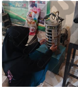
Gambar 6. Uji Analisis Saringan
