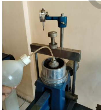
Gambar 15. Proses Pengisian Air Pada Alat Oedometer
