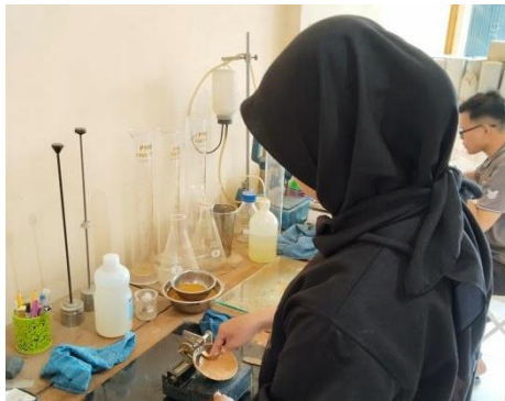
Gambar 12. Proses Uji Batas Atterberg
