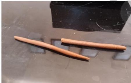
Gambar 11. Uji Batas Plastis (PL)
