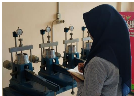
Gambar 16. Proses Pembacaan Dial Gauge Pada Sampel
