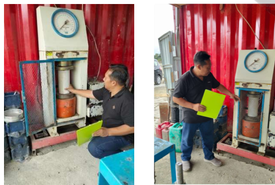
Gambar 3. 8 Pengujian Kuat Tekan beton
