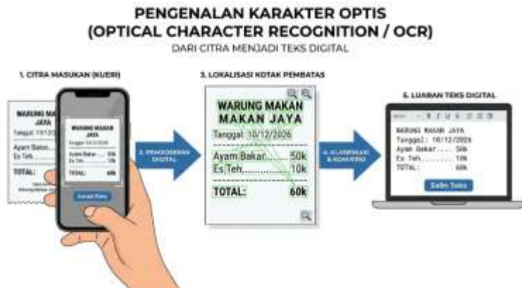
Gambar 11. Diagram Mekanisme Kerja OCR (Deteksi & Klasifikasi)
