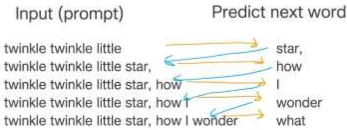
Gambar 17. Mekanisme Generatif Autoregresif melalui Prediksi Kata Berikutnya secara Berulang (Iterative Next-Word Prediction).
